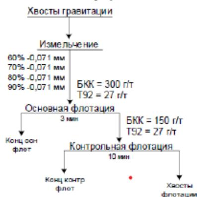
Рисунок 2 – Схема выполнения тестов по выбору оптимальной крупности измельчения.
