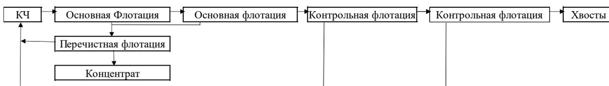
Рисунок 15 – Упрощенная технологическая схема с минимальным выходом концентрата
